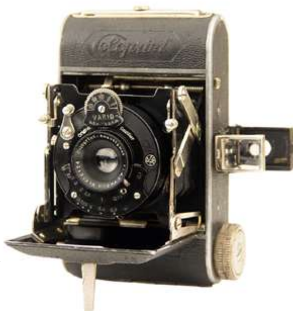
Non comune primo tipo di Zeh-Zeca Coloprint con obiettivo Coloprint 5cm f/4,5 montato su otturatore Gauthier. Notare la messa a fuoco fino a 0,5 metri e la presenza del foro, a fianco della distanza di 0,75 metri per l'autoscatto a filo.
