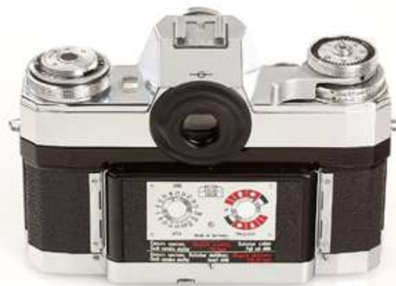
Contarex I del terzo tipo con dorso magazzino
