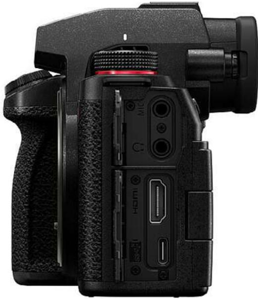
*Lato sinistro: lo sportellino inferiore nasconde una porta HDMI Type A e una porta USB 3.2 Gen2 Type-C, quello superiore il jack per il microfono e per le cuffie.*
