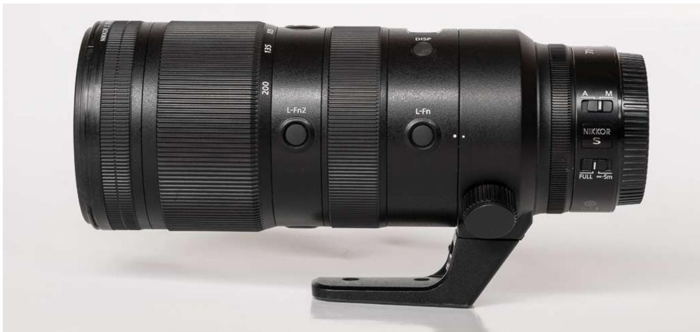
Lo zoom Nikkor Z 70-200mm f/2.8 VR S è il classico tele-zoom professionale. Vanta una costruzione protetta dagli agenti atmosferici, un motore AF del tipo passo-passo e lo stabilizzatore ottico VR che opera insieme a quello della macchina. La messa a fuoco parte da 50 centimetri (a 70mm) oppure da 100 centimetri (a 200mm) e pesa 1440 grammi, quindi all'incirca quanto la Z9.
